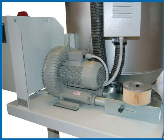
Die Heißlufttrockner ernste SH, ich bin vollständige Einheit, ihr macht eine Fahraufnahme mit Luftmengen von 180 zu 250 m<sup>3</sup>/h und Volumen von Trichter von 400 zu 800 Litern.
